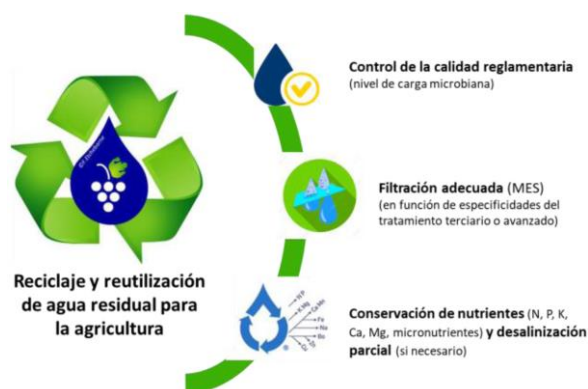
Figura 1. Aspectos técnicos del reciclaje y de la reutilización de agua residual urbana para la agricultura (© F. Etchebarne).
