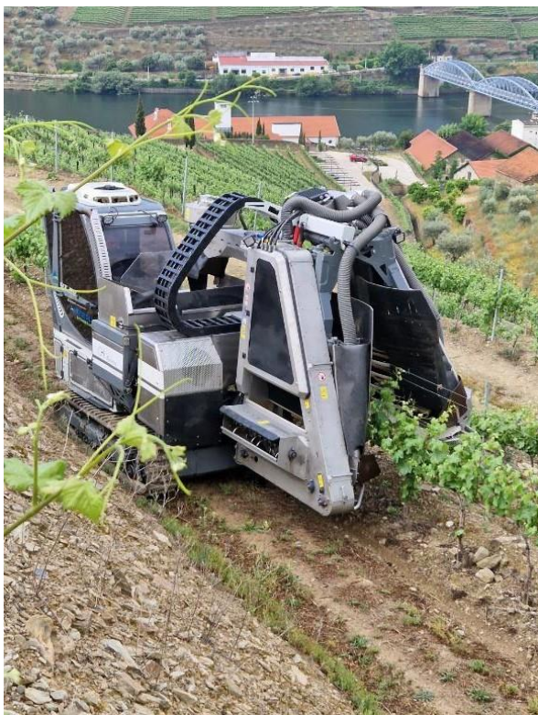
Photo 10. Machine à vendanger sur chenillettes adaptées au vignoble en banquette développée en Allemagne par Marcus Hoffmann à partir d'expérimentations allemandes et portugaises, photo J. Rochard.
