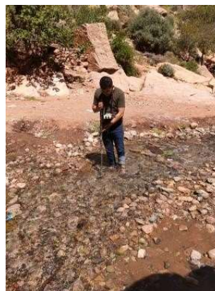
Photos n° 3 et 4 : Jaugeages des débits au micro moulinet des sources de l'oued M'Hasser (Bouyzillan, 2022).
