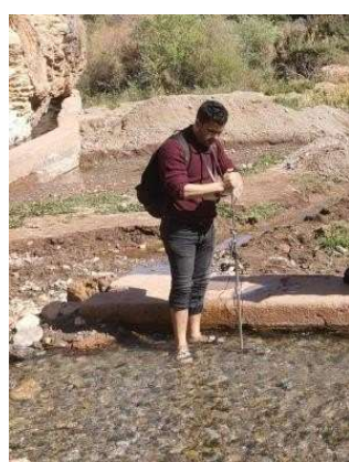
Photos n° 3 et 4 : Jaugeages des débits au micro moulinet des sources de l'oued M'Hasser (Bouyzillan, 2022).
